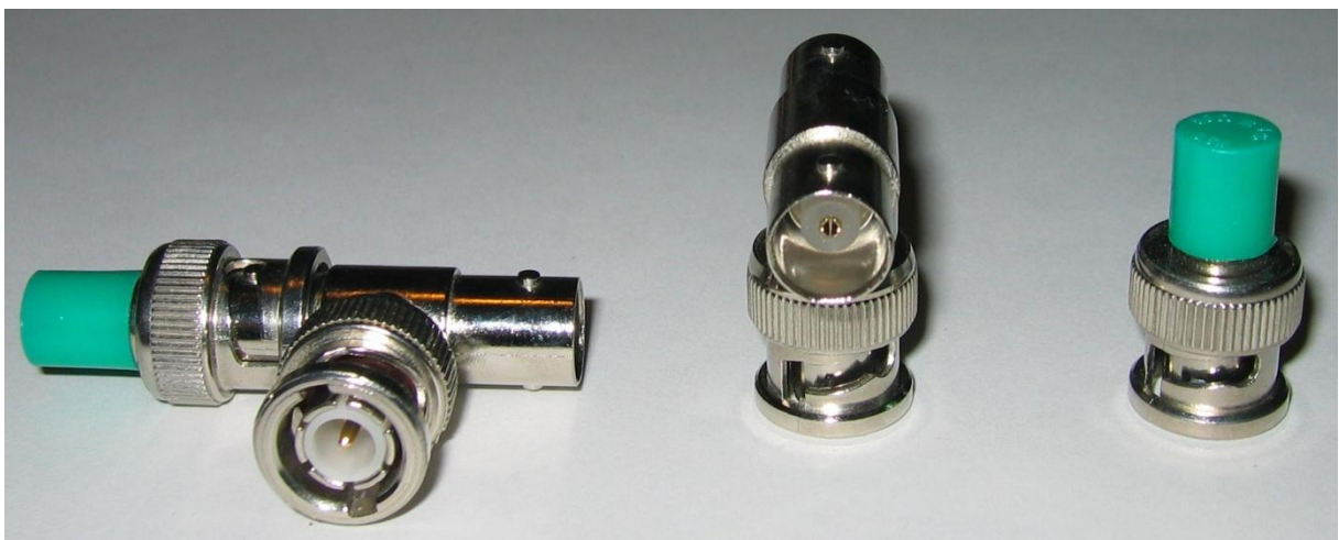
Obrázek 3. BNC-T konektory používané na rozbočení signálu a terminátor
